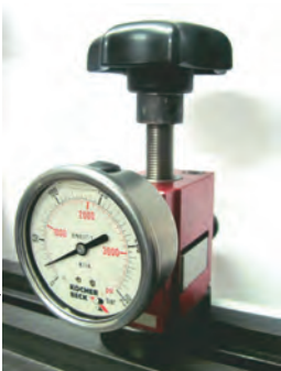
Imagem 5: sistema de controle de pressão.
